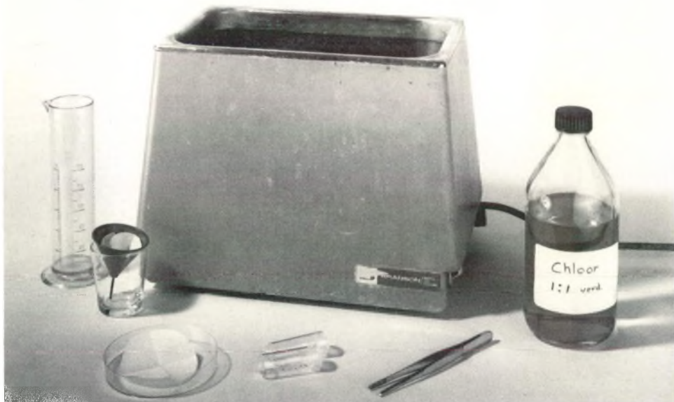
Afb. 1 Een overzicht van de benodigdheden welke gebruikt worden voor het ultrasoon reinigen van kleine schelpjes. Zie: benodigdheden 1 t/m 7.
