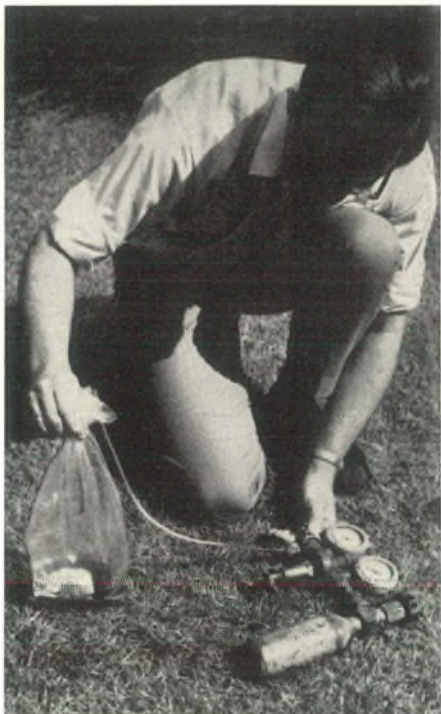
Afb. 6. Het opblazen van de transportzakjes met zuivere zuurstof. De linkerhand bedient het reduceerventiel.
