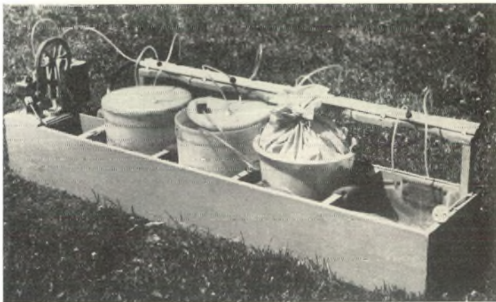
Afb. 4. Transport-unit voor de VW-bus. Luchtvoorziening d.m.v. de acculuchtpomp. Verklaring in de tekst.
